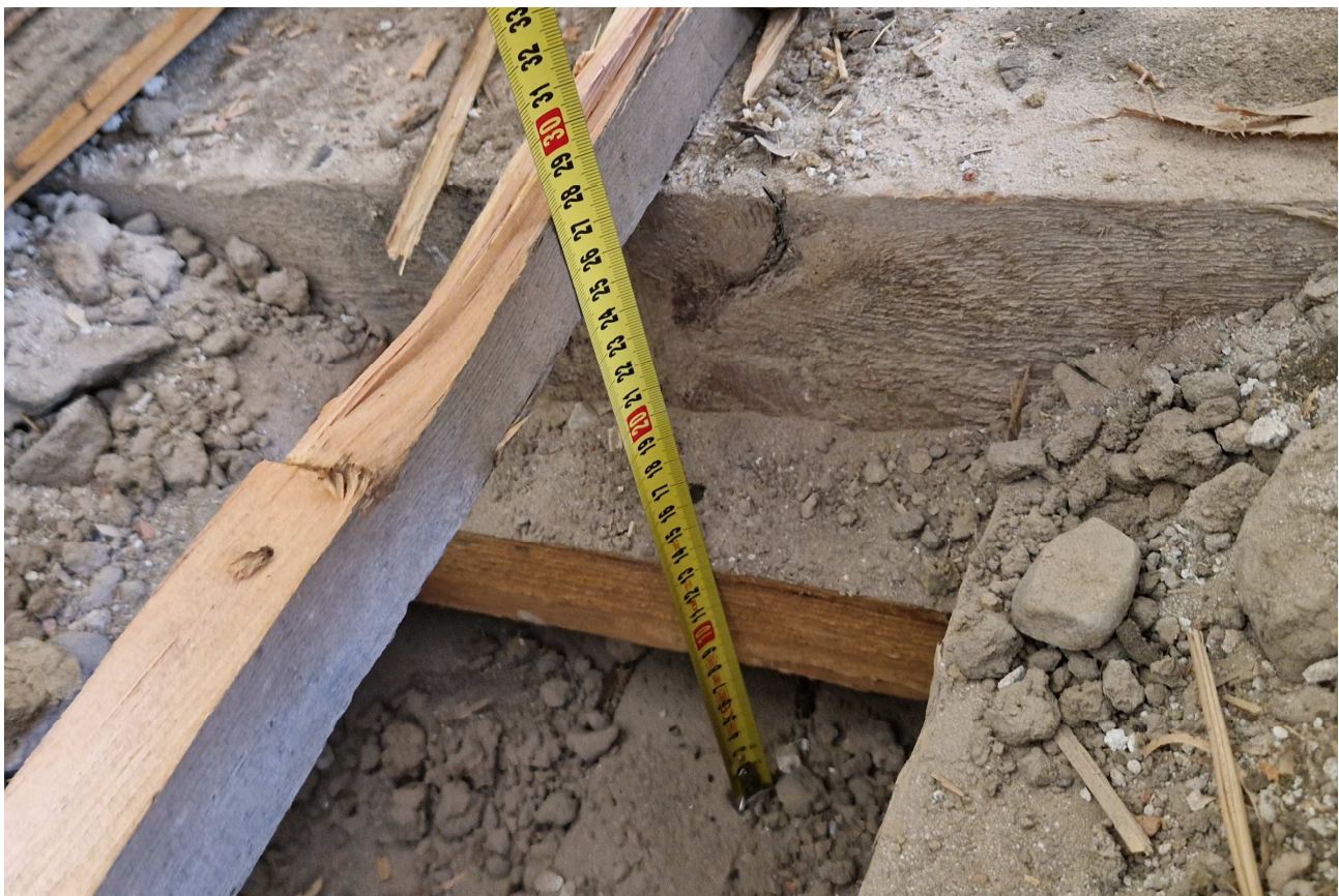
Foto 5. Pomiar wysokości belek nośnych stropu nad parterem.
